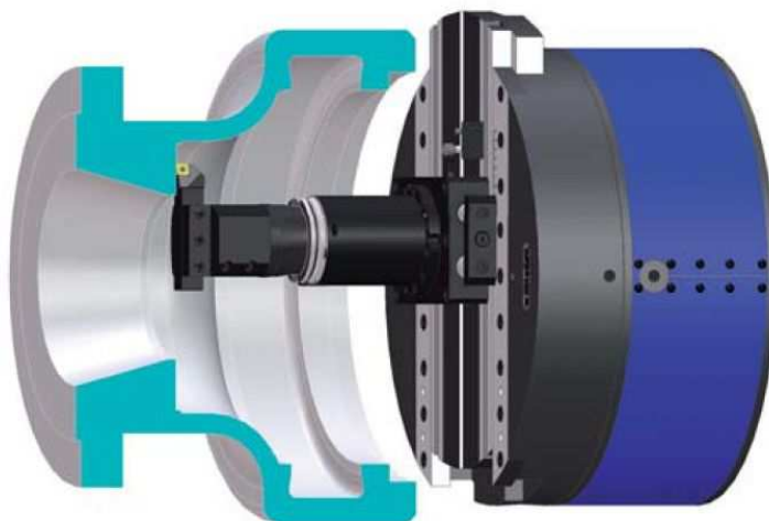
Rys. 1 Przykład wykorzystania głowicy mechatronicznej typu U-TRONIC firmy D'Andrea.
