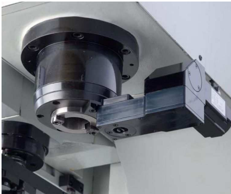
Rys. 3 Napęd U-DRIVE zamontowany na wrzecionie frezarki pionowej.
